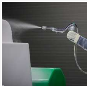
2. Application du gelcoat, qui donnera la couleur du bassin
